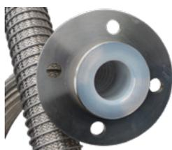
Ce sont des flexibles moyenne pression ou dépression, destinés aux industries chimiques et pétrochimiques. Constitués d'un tube PTFE convoluté en hélice, et revêtus d'une tresse inox haute ténacité suivant AISI 304 (sur demande : polypropylène, PVDF), ils peuvent être équipés de tous types de raccords industriels (possibilité de raccords revêtus PTFE). Ainsi que les types d'Aflex extrêmement flexibles avec une paroi intérieure lisse (Corroline+, Bioflex-Ultra et Hyperline)
